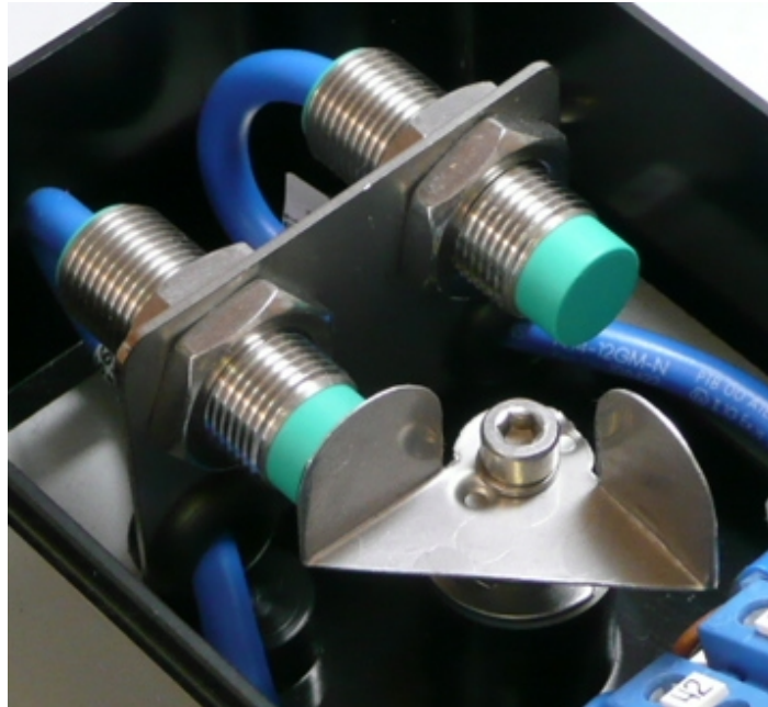
Abb.: Innenansicht der Pepperl+Fuchs Sensoren NJ-12GK-N mit 0 und 90° Schaltfahne
