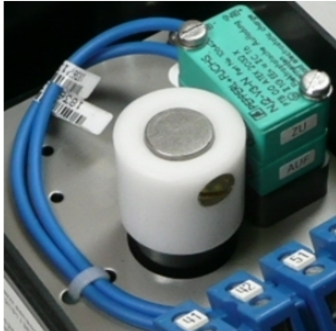
Abb.: Innenansicht der Pepperl+Fuchs Sensoren NJ2-V3-N mit 0 und 90° Schaltnocke
