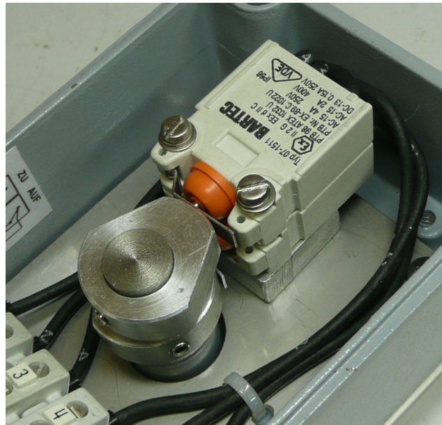
Abb.: Innenansicht der mechn. Bartec Ex d... Endschalter mit verstellbaren Schaltnocken 0 - 180°
