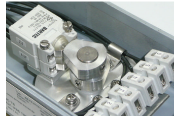
Bartec-Endschalter: mechn. druckfest gekapselt
