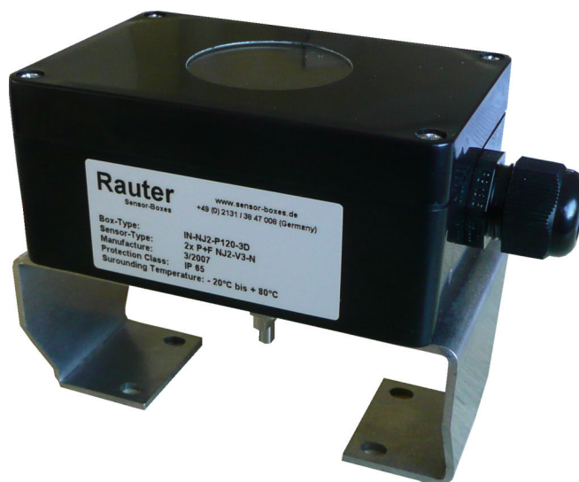
Bild 1: Polyamid(Vestamid)-Sensor-Box, 120x80x55mm für Antriebe nach VDI/VDE 3845 mit 20mm Wellenüberstand
